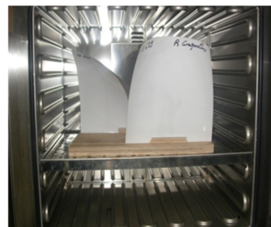
Essai : Résistance de la surface à la chaleur sèche en étuve à 70°C
