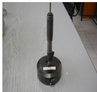
Essai de Résistance au choc d'une bille de petit diamètre
