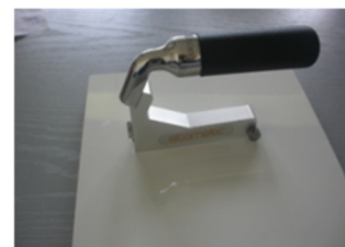
Essai : Mesure de l'épaisseur du feuil sec au choc (support bois)
