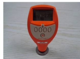
Essai : Mesure de l'épaisseur du feuil sec (support métallique)
