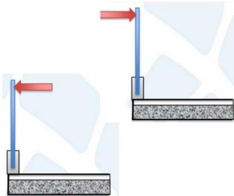
Chargement : Application d'une force répartie sur la barre d'appui d'une valeur qui peut atteindre jusqu'à 1.7 KN/m selon le type et l'emplacement du garde corps.
