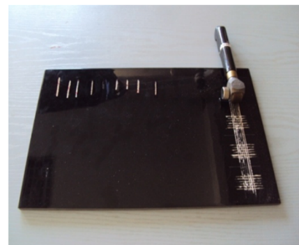
Essai : Adhérence par Quadrillage des Feuille
